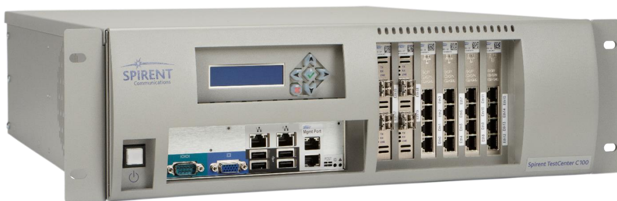
Генератор трафика C100 в конфигурации 4x10G и 16x1G
